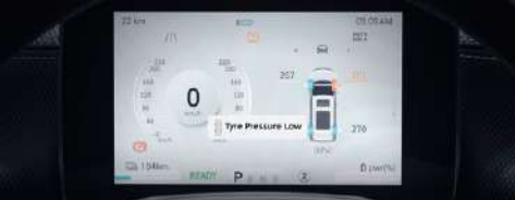
TPMS (TIRE PRESSURE MONITOR SYSTEM) ระบบวัดแรงดันลมยางอัตโนมัติ ช่วยตรวจสอบแรงดันลมยางของแต่ละล้อได้ หากพบความผิดปกติจะแจ้งเตือนที่หน้าจอทันที
